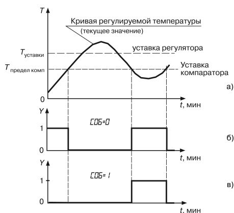
Рисунок 7.20 – Блокировка срабатывания компаратора до первого достижения уставки
