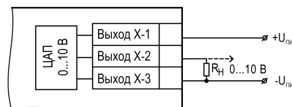
Рисунок 5.20 – Схема подключения нагрузки к ВУ типа У
